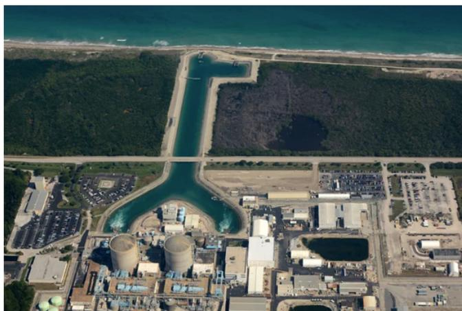
Ilustración 2: Captación directa con diques (St Lucie Nuclear Power Plant, Ramey Logan. Fuente: Wikimedia Commons)
